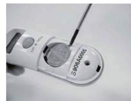
图7 将新电池斜放入卡勾下，再压下电池。
